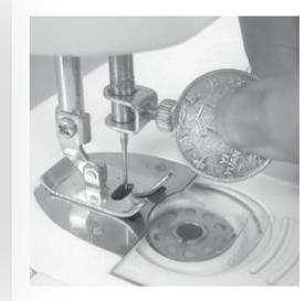
Coloque em seu lugar uma nova agulha com o lado achatado para trás, e empurre-a até o topo. Aperte firmemente o parafuso de fixação da agulha.
