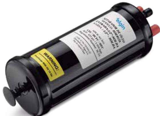
Los Separadores de Aceite Elgin fueron proyectados para el retorno de aceite al compresor en cualquier condición de funcionamiento. El retorno automático de aceite al compresor mejora la eficiencia del sistema mediante la reducción de la película de aceite sobre las paredes internas de los tubos del condensador y evaporador. Mantiene constante el nivel de aceite, aumentando la vida del compresor. Se pueden utilizar con fluidos R-134a, R-22, R-404A y mezclas.
