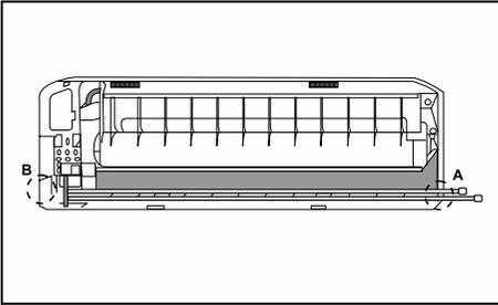
1. Com uma faca, destaque a tampa removível existente na parte de trás da unidade interna (exceto se você pretende fazer a ligação diretamente por trás).
