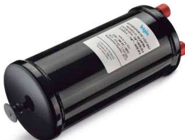
Los Separadores de Líquido Elgin protegen el compresor contra el retorno de refrigerante en forma líquida. Tienen un tubo en "U", con orificio calibrado, que proporciona el retorno dosificado de aceite y refrigerante al compresor.
