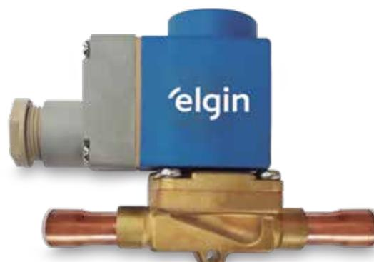
Las Válvulas Solenoide Elgin fueron proyectadas para operar en la línea de líquido. Conexiones de Rosca (SAE) y Soldable (ODF) para fácil instalación. Bobinas encapsuladas de larga duración, proporcionando protección contra la humedad, choque eléctrico y vibraciones. Se pueden utilizar con fluidos R-134a, R-22, R-404A y mezclas.
