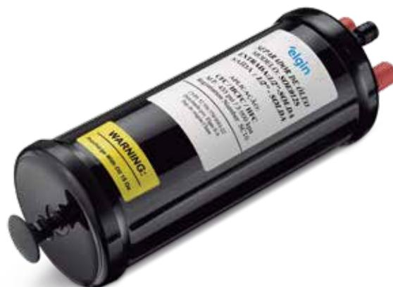
Los Separadores de Aceite Elgin fueron proyectados para el retorno de aceite al compresor en cualquier condición de funcionamiento. El retorno automático de aceite al compresor mejora la eficiencia del sistema mediante la reducción de la película de aceite sobre las paredes internas de los tubos del condensador y evaporador. Mantiene constante el nivel de aceite, aumentando la vida del compresor. Se pueden utilizar con fluidos R-134a, R-22, R-4O4A y mezclas.
