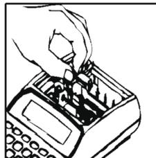
3. Coloque o novo rolete, encaixando-o corretamente no suporte. Certifique-se de que o rolete esteja corretamente encaixado (Fig.3).
