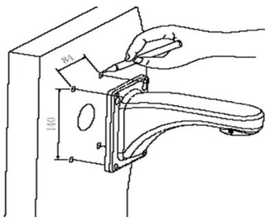
Para a instalação ser feita na parede como o exemplo abaixo, será necessário uso de parafuso e bucha 8mm:
