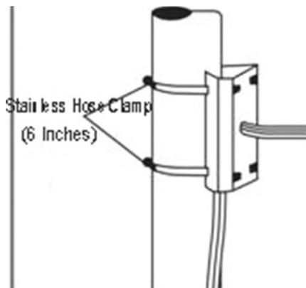
Após a fixação do suporte, a câmera deverá ser fixada respectivamente na furação como no exemplo abaixo: w
