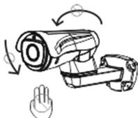
Não movimente o conjunto de mecanismos do produto com as mãos, poderá danificar por forçar os mecanismos internos.
